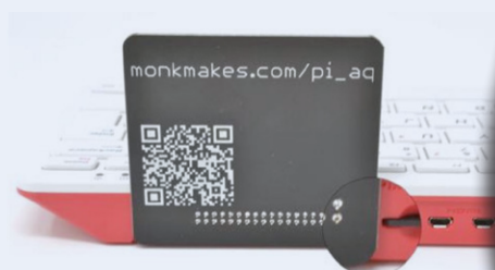
Figure 2. Kit de qualité de l'air connecté à un Raspberry Pi 400. (Source : MonkMakes)
