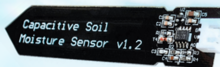
Figure 3. Exemple de capteur capacitif basse fréquence. (source : [3]).
