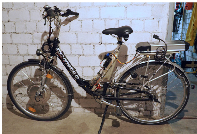
Figure 1. Avant : mon vélo avec un moteur de moyeu avant et un câblage improvisé.
