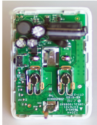
Figure 27. Les broches du milieu sont soudées.
