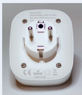
Figure 9. Quatre vis ferment le boîtier de l'EU6S.
