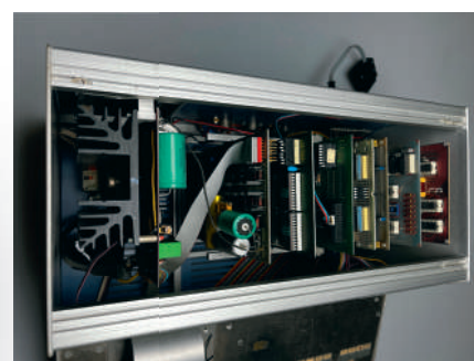
Aperçu d'un système SC/MP complet donné à Elektor Retronics en 2021. Le boîtier est ouvert pour révéler le fond de panier DIN-64C avec l'unité centrale et diverses cartes d'extension connectées.
