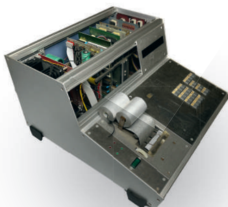
Aperçu d'un système SC/MP complet donné à Elektor Retronics en 2021. Le boîtier est ouvert pour révéler le fond de panier DIN-64C avec l'unité centrale et diverses cartes d'extension connectées.
