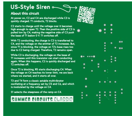
de répétition du modulateur. Lorsque la rampe atteint la limite inférieure (environ 1,3 V avec une tension d'alimentation de 3 V), T2 est activé et recharge rapidement les condensateurs. Lorsque la tension aux bornes de C4 (+ C7) atteint la limite supérieure (environ 2,4 V pour une alimentation de 3 V), T2 se désactive et la rampe recommence.
