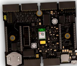
La commande Arduino Edge est une solution de surveillance et de contrôle à distance, optimisée pour les environnements extérieurs. Il peut être positionné n'importe où et convient à l'agriculture de précision, à l'agriculture intelligente et à d'autres applications nécessitant un contrôle intelligent dans des endroits éloignés. L'alimentation peut être fournie soit par un panneau solaire, soit par une entrée CC.
