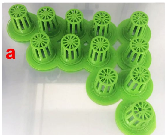
Figure 4. Godets ajourés imprimés en 3D (a) et système d'essai monté (b).
