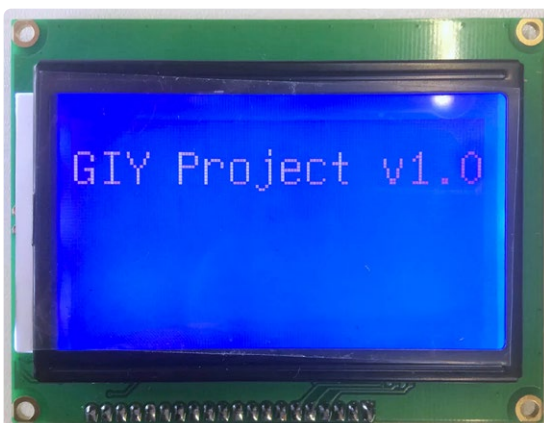
Figure 9. Le LCD utilisé a une résolution de 128×64 pixels, seules 3 broches le relient à la carte.
