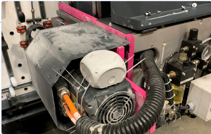
Figure 4. Mesure des vibrations avec un accéléromètre. (Source : Würth Elektronik eiSos)
