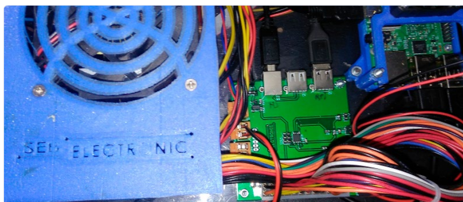
Figure 4. Alimentation ATX connectée au PCB.
