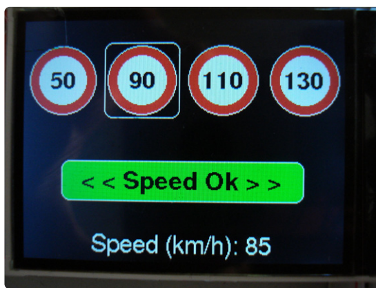
Figure 3. L'écran 1 montre les limitations de vitesse sous la forme de panneaux de signalisation ronds accompagnés d'un bref message.
