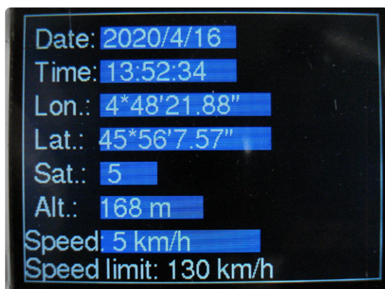
Figure 6. Les données GPS sont disponibles sur l'écran 3. C'est également par cet écran qu'on accède à l'écran 4 de programmation des valeurs des limites de vitesse.
