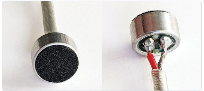
Figure 7. Petite capsule d'électret avec membrane de 5 mm.
