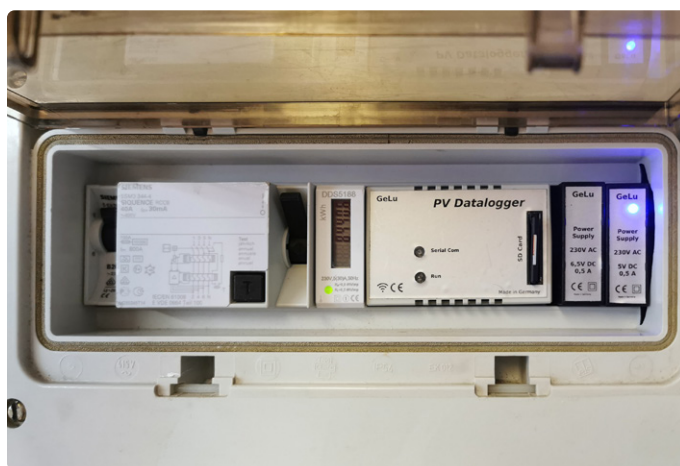
Figure 1. L'enregistreur de données énergétiques finalisé avec l'appareil de mesure et le bloc d'alimentation, installé dans un petit boîtier en matière plastique.
