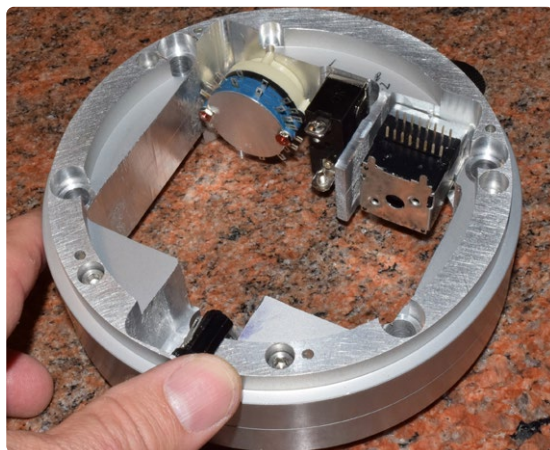
Figure 16. Les commandes (commutateur d'entrée, interrupteur d'alimentation et potentiomètre de volume) sont montées sur un anneau d'aluminium usiné distinct.
