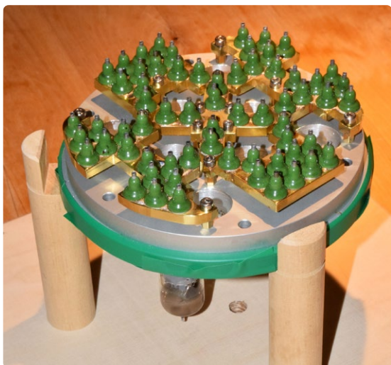
Figure 12. Plots de soudure avec isolateurs en verre vert presque vintage.
