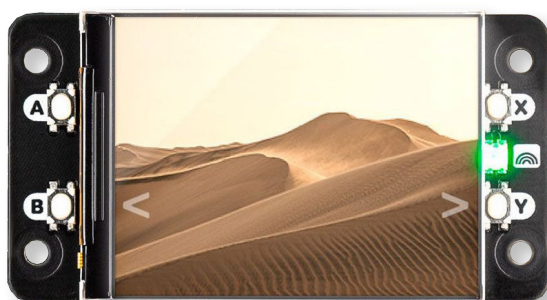
Figure 1. L'afficheur HAT Mini dispose également de quatre boutons poussoirs et d'une LED RGB.
