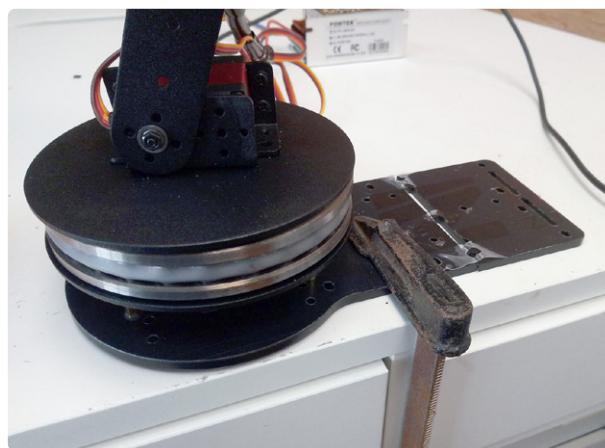
Figure 6. Fixer le bras du robot au plan de travail permet de rendre les expériences plus sûres.
