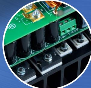
Transistors de puissance TO-264-5 et pilotes TO-220 montés au milieu sous le circuit imprimé
