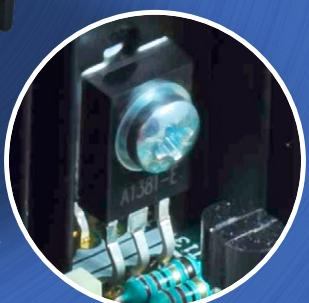
Les rondelles isolantes en céramique assurent un excellent couplage thermique avec le dissipateur
