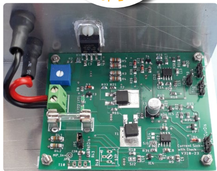
Figure 1. À gauche, le puits de courant sans booster et avec un grand radiateur. Fixer le LM317 avec une vis en plastique était une mauvaise idée ! À droite, la carte complète avec le booster (et vis métallique).
