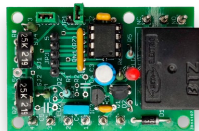
Figure 4. Le générateur de code morse construit sur la carte universelle pour projet PIC à huit broches de l'auteur.
