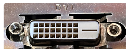
Figure 24. Prise DVI-D sur un PC (source : Dr. Thomas Scherer).
