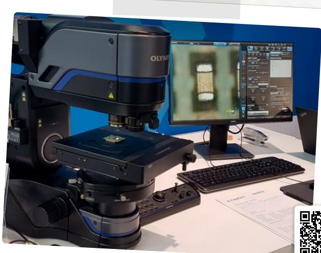
Les microscopes optiques sont de plus en plus remplacés par les microscopes numériques. Ils sont conviviaux, même pour les opérateurs peu familiarisés avec la microscopie, et permettent de scanner automatiquement les échantillons. Le modèle Olympus présenté ici fournit même des images en 3D qui peuvent être visualisées sous tous les angles.
