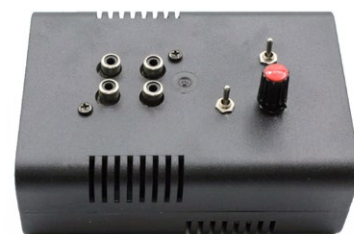
Figure 4. Prototype de l'auteur : les entrées et sorties, ainsi que les deux interrupteurs et le potentiomètre de réglage du niveau de distortion, sont situés sur le dessus.
