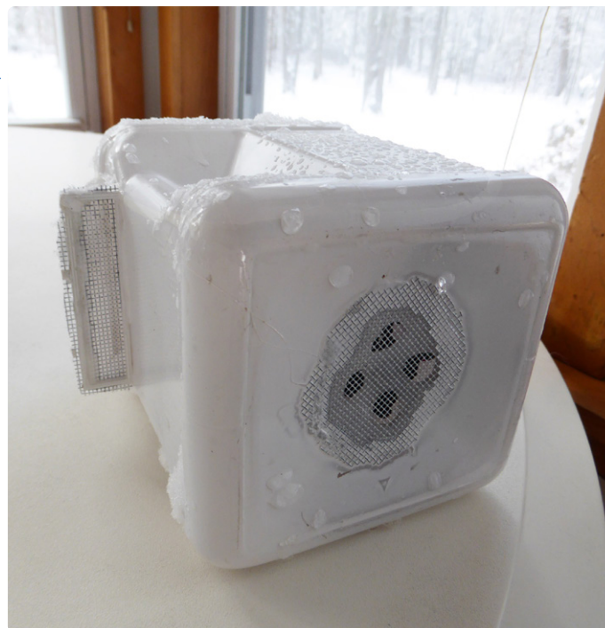
Figure 9. Détail du boîtier du capteur. Tous les orifices d'aération sont grillagés pour protéger des attaques biologiques plus que des cyberattaques ;-).
