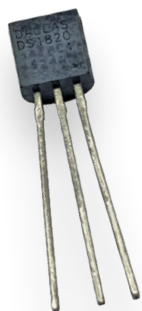
Figure 1. Le DS18B20 dans un boîtier TO-92.
