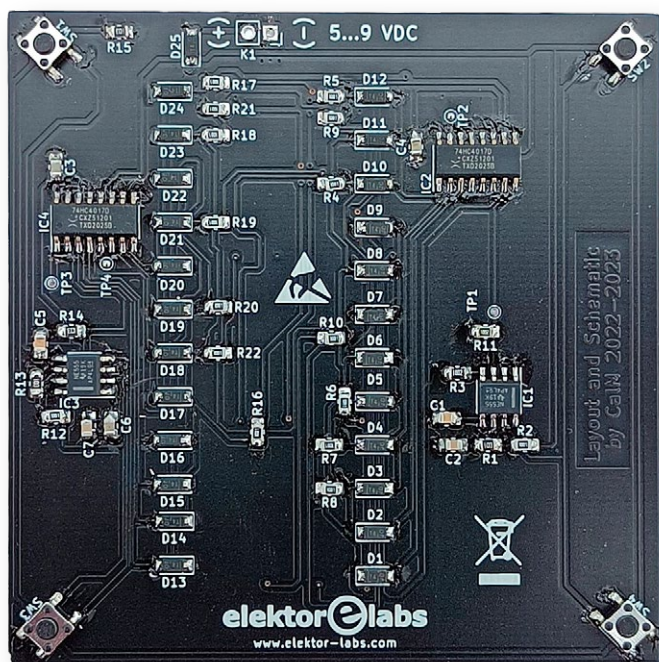
Figure 3. Bien que tous les composants soient CMS, il y a suffisamment d'espace pour assembler confortablement les dés.
