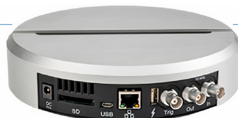
Figure 1. Le Moku:Lab dispose de deux entrées et deux sorties analogiques. La fente sur le dessus du boîtier sert de support de tablette.
