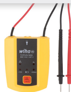
Le résultat de la mesure est signalé par la LED et le signal sonore.
