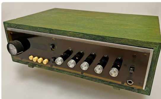
Figure 3. Le boîtier en bois, assemblé et peint à la main. Il loge deux cartes Edwin de 20 W ainsi que le syntoniseur FM d'Elektor de 1974.
