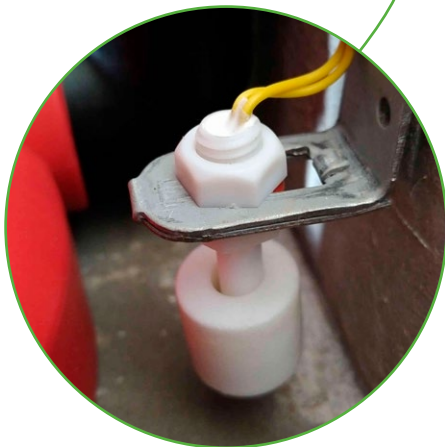
Figure 2. Le capteur de niveau d'eau contient un relais Reed ; l'anneau est un électroaimant.
