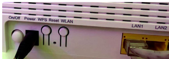
Figure 6. Bouton WPS et indicateur d'un point d'accès typique.
