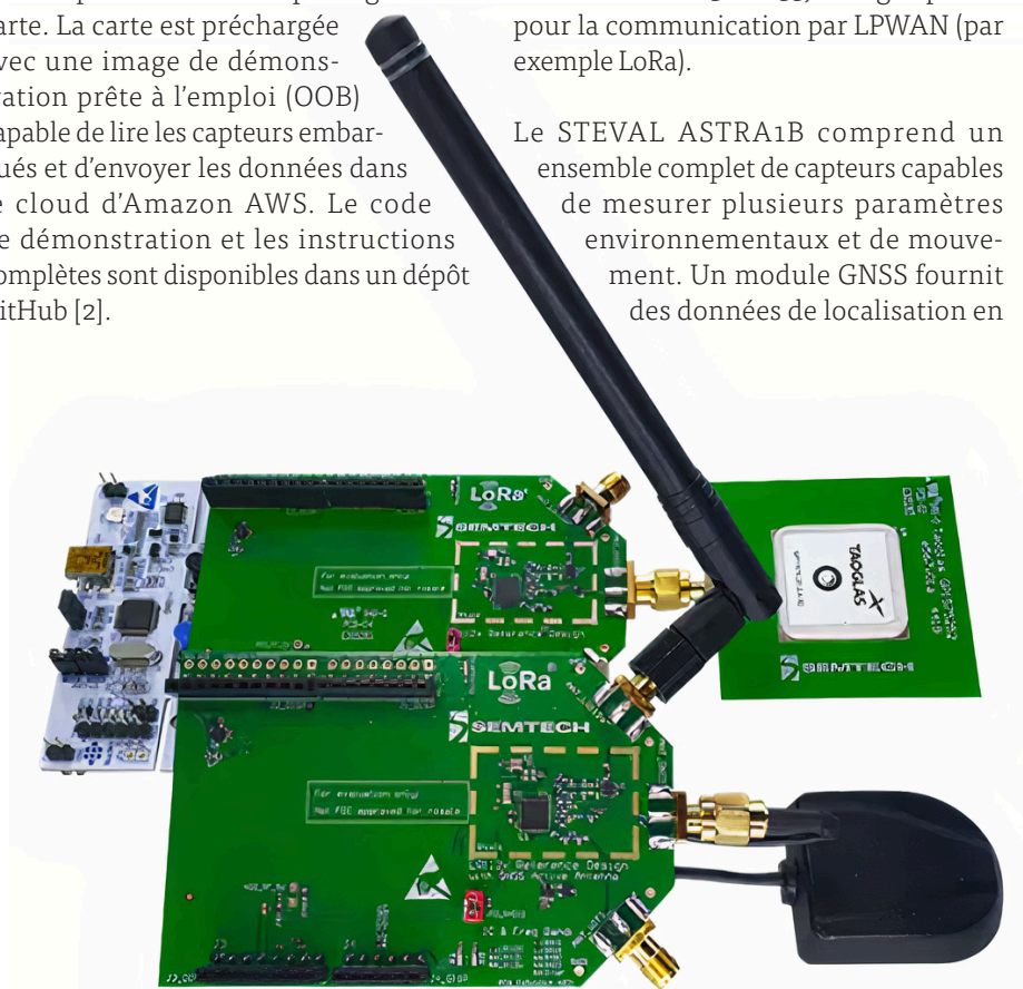
Figure 5. Un exemple de kit de développement LR1120 proposé par SEMTECH (Source : SEMTECH).
