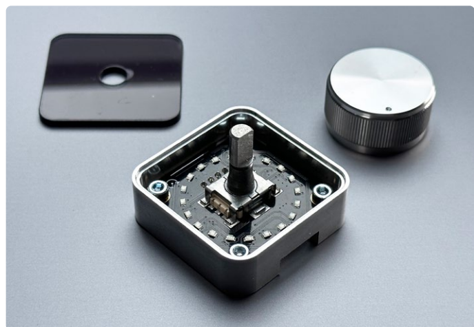
Figure 23. Le boîtier usiné avec l'encodeur monté.
