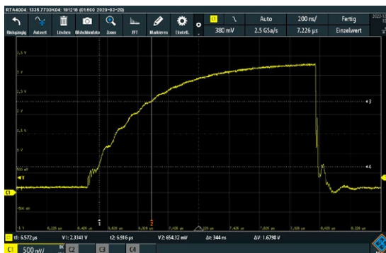
Figure 6. Mesure de référence avec résistances de rappel de 1 kΩ, ferrite CMS multicouche, réseau de diodes TVS, fils de 20-cm, et 400-pF MLCC (= 344 ns de temps de montée).
