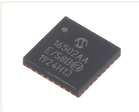
Figure 1. Format VQFN32 permet de fermer le circuit dans un boîtier avec une base de 5 × 5 mm.
