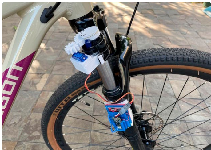
Figure 3. Installation du projet sur la suspension avant d'une bicyclette. En haut, le servomoteur qui règle la raideur de l'amortissement.
