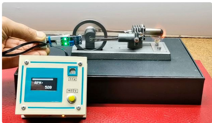
Figure 5. Recyclage : l'auteur a réutilisé le coffret d'un projet précédent pour y accueillir l'afficheur et le capteur.
