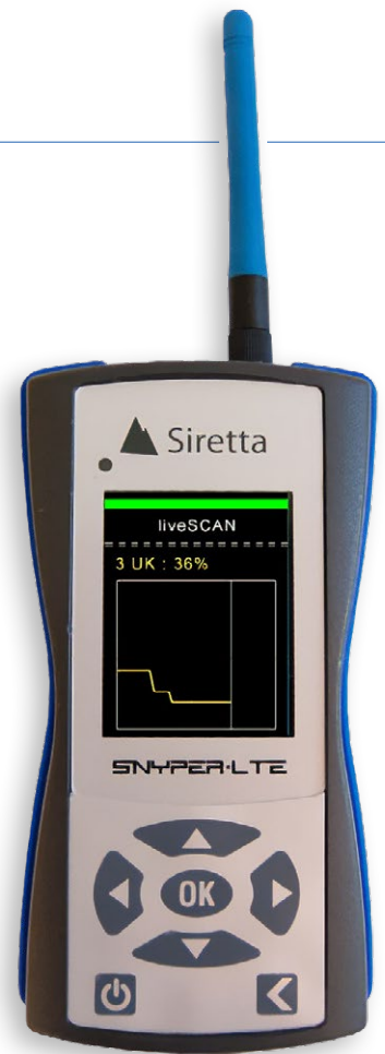
Figure 1. L'analyseur de réseau SNYPER-LTE Spectrum fournit une multitude de données qui facilitent le choix de l'antenne et permettent de définir l'emplacement idéal pour installer l'équipement sans fil cellulaire.
