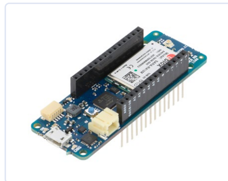
Figure 7. Module Arduino MKR NB 15 pour la communication dans les réseaux Narrowband IoT.
