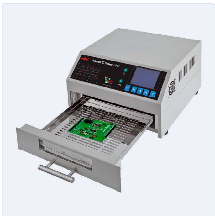
Figure 9. Le four de refusion à infrarouge T-962.
