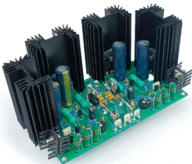
Figure 10. Circuit imprimé entièrement assemblé : le kit de régulateur de tension linéaire Elektor \pm 40 V.
