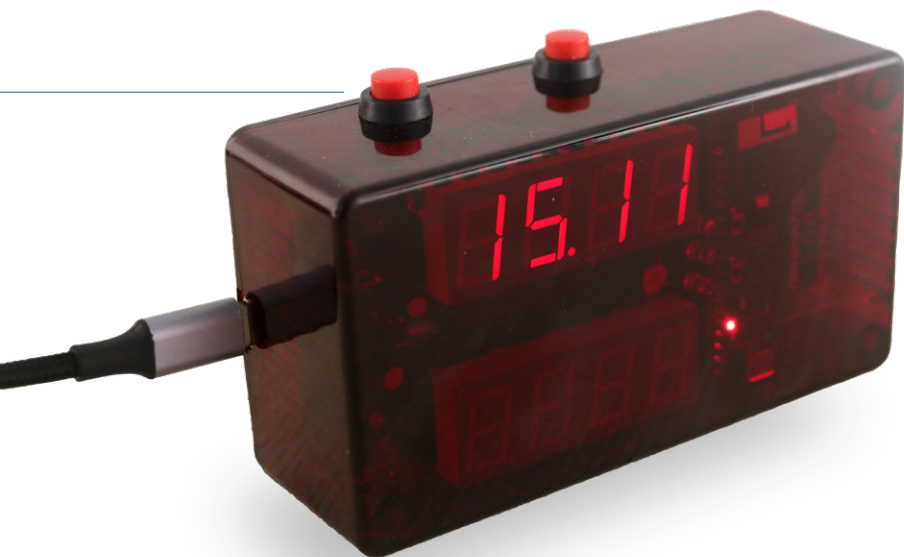
Figure 4. Notre horloge Cloc terminée, alimentée par un adaptateur USB-C.
