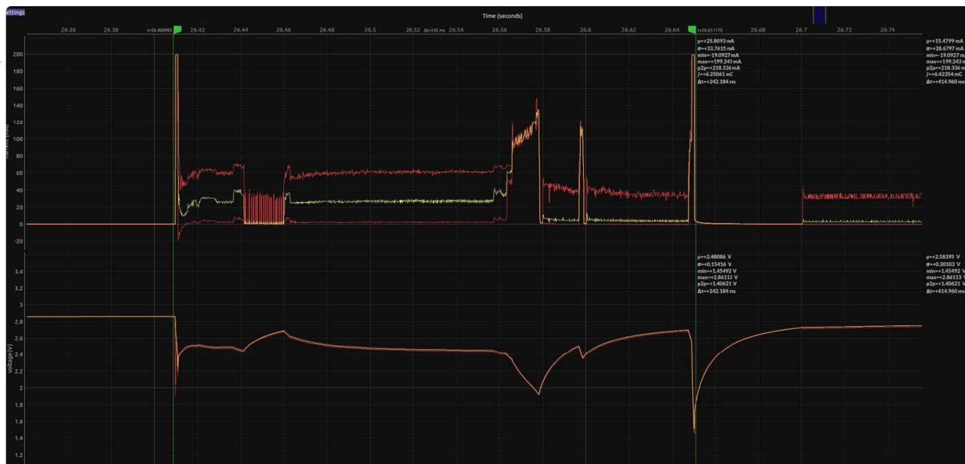
Figure 5. Oscillogrammes de la tension et du courant absorbé durant la transmission d'un paquet de données standard.
