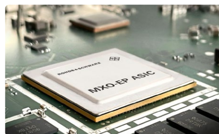
Figure 2. Un coup d'œil à l'intérieur révèle un ASIC 200 Gbit/s sur mesure : le MXO-EP, doté d'une grande puissance de traitement du signal.
