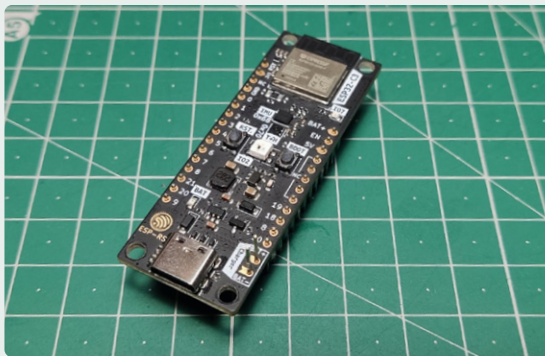
Figure 3. L'ESP32-C3 intègre un module de débogage USB avec une interface série, ce qui évite d'avoir recours à des sondes externes.
