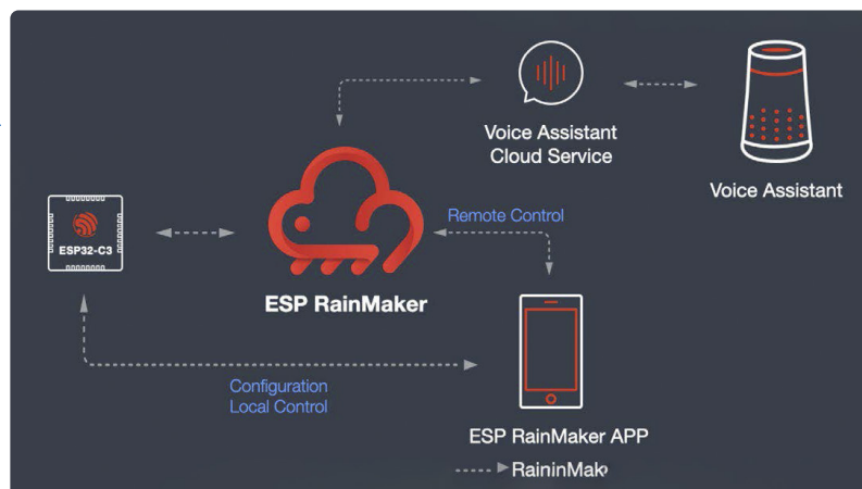
Figure 3. Composants de l'ESP RainMaker.
