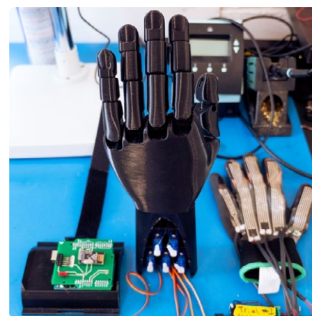
Figure 6. En exploitant les variations de résistance de l'encre conductrice sur un substrat extensible, les jauges de contrainte situées dans les doigts de ce gant pourraient contrôler une main robotisée.
