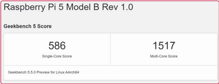
Figure 1. Résultats du benchmark avec Geekbench 5 pour le Raspberry Pi 5, 8 GB.
