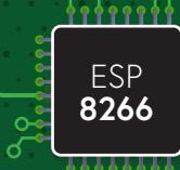
Micro-contrôleur Tensilica 32 bits
