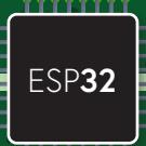
Microcontrôleur Tensilica 32 bits
