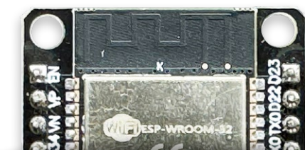
Figure 1. L'antenne quart d'onde en forme de F « imprimée » sur une carte ESP32.
