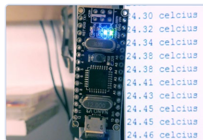
Figure 4. La carte Arduino Nano utilisée dans ce projet, avec les lectures indiquées à droite.
