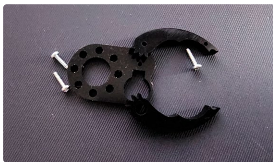
Figure 3. Pince de robot micro plastique Actobotics.
