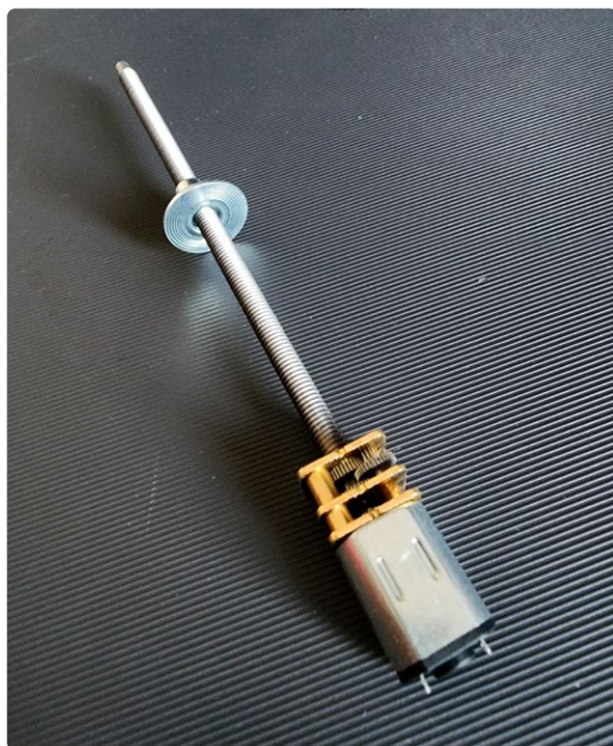
Figure 2. Moteur N20 avec un arbre M4 de 100 mm.
