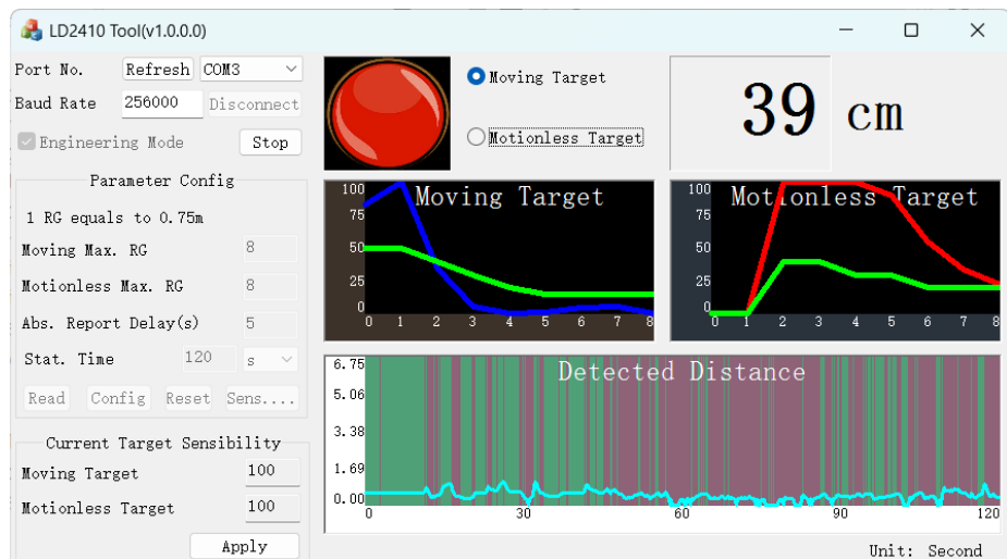
Figure 5. Pour configurer le radar, utilisez l'outil appelé LD2410 Tool.
